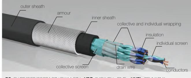
**BS**: CU/PE/ISCR/OSCR/LSZH/SWA/LSZH - **VDE**: 2Y(St)HRH - PIMF - **UNEL**: REHM1FM1
